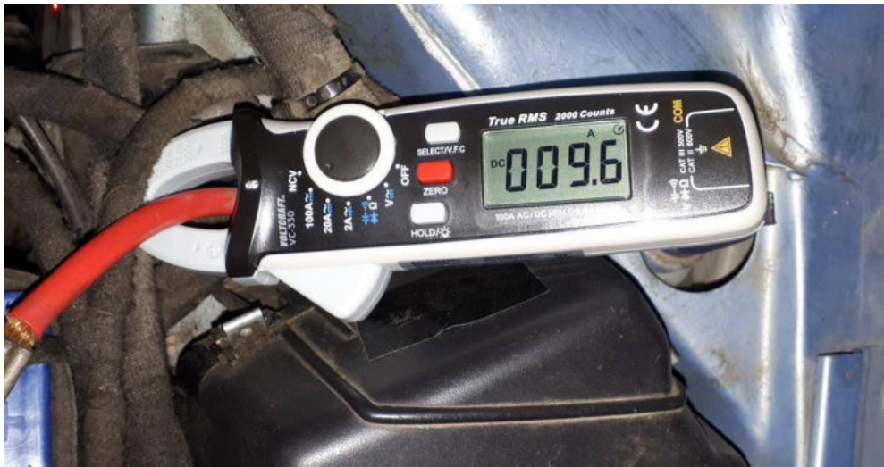
22. ábra. Punto 2b - mérés egyenáramú lakatfogóval a kormányvezérlő 12V betáplálásánál Forrás: szerző képe
