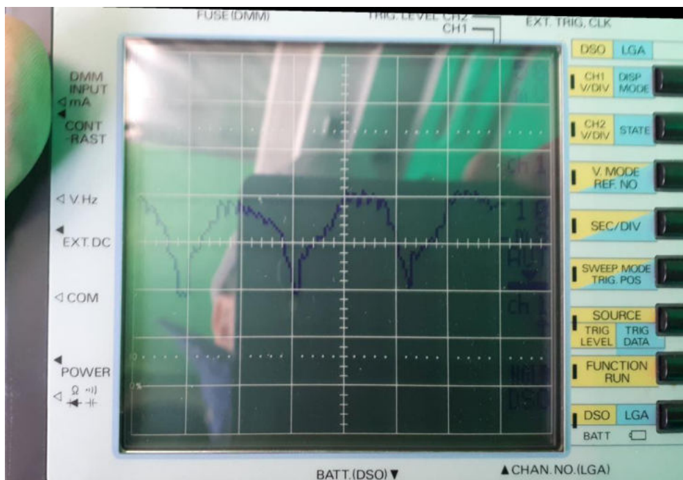
24. ábra. Háromfázisú gépjármű generátor oszcillogramja az akkumulátor kapcsain mérve (alapjáraton)
