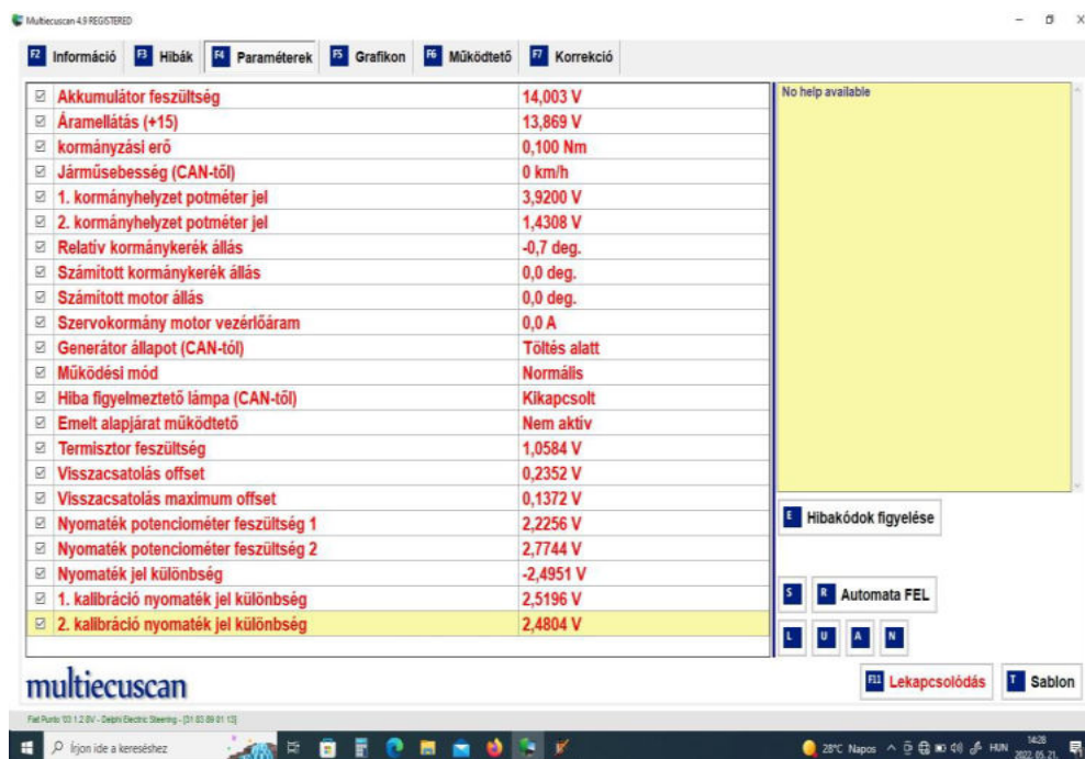
23. ábra. MultiEcuscan - szervókormány diagnosztikai ablak Forrás: szerző képe
