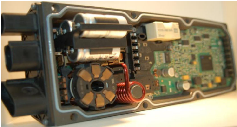
7. ábra. Az EPS-apa típusú szervokormány elektronikája Forrás:[19]
