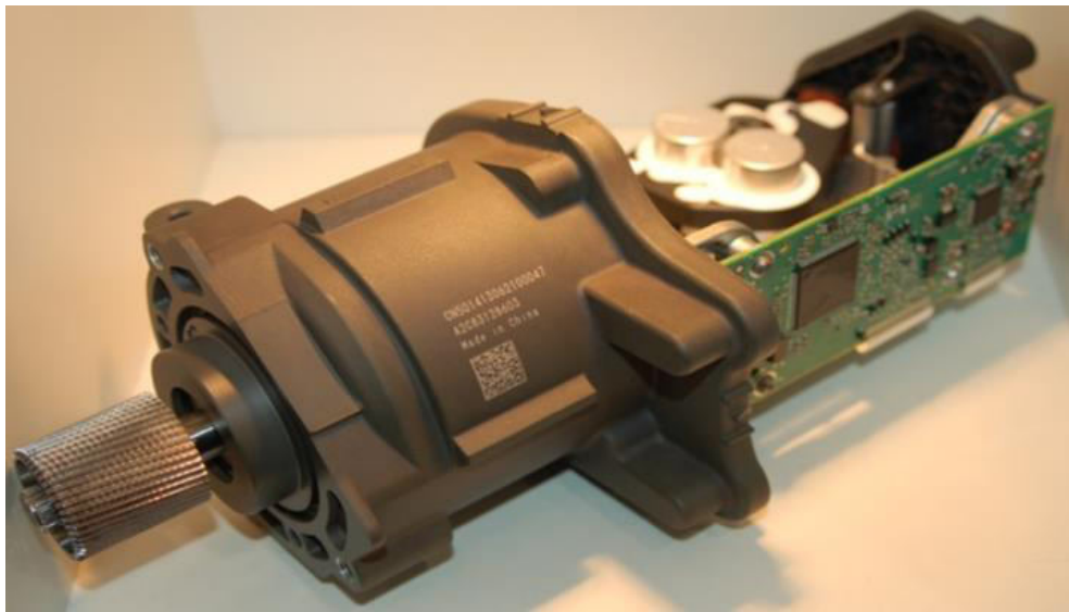
6. ábra. Az elektromechanikus szervokormány villanymotorja és a közvetlenül rá szerelt elektronika. Forrás:[19]
