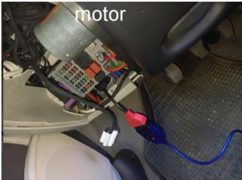
14. ábra. Csatlakozás a FIAT Punto EOBD interfészéhez egy KL/USB kábelrel és egy FiatEcuscan adapterkábelrel keresztül. Képen látható a kormányrásegítés motorja.
