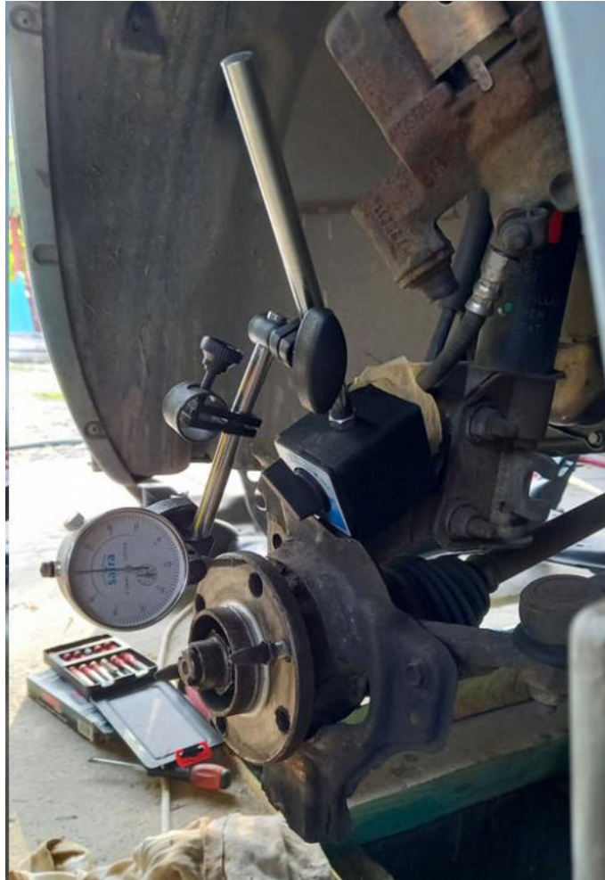
30. ábra. Kerékagy ellenőrzése oldalirányú ütésre Forrás: szerző képe
