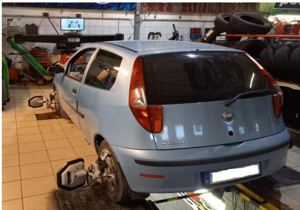
38. ábra. A nevezett jármű a nevezett futóműbeállító padon Forrás: szerző képe (TyreTrans Kft. Miskolc)
