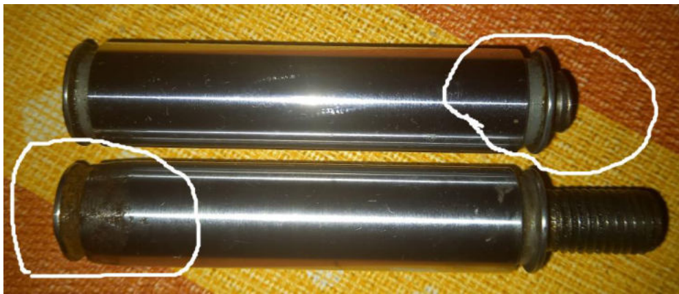
29. ábra. Hibás úszónyereg vezetők. Egyiket elverték, majd köszörűvel igazították, a másik beletört az úszónyeregbe Forrás: szerző képe
