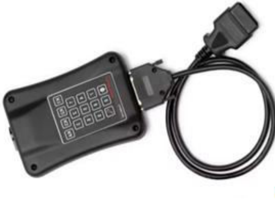
40. ábra. Hunter Code Link elektromos kormányrúgató újrakalibráló interfész Forrás: [13]
